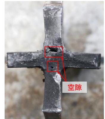
図8 溶接部の空隙
