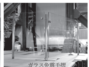
ガラス免震手摺 免震稼動実験の様子
