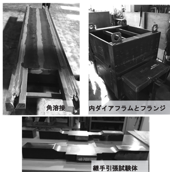
写真7 溶接施工試験および機械試験
