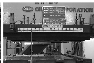
写真2 QTB載荷実験状況
