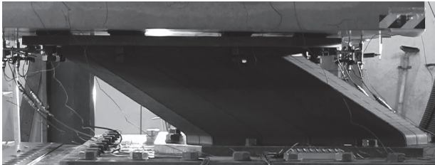
TOS システム せん断引張試験状況 (撮影：オイレス工業株式会社)
