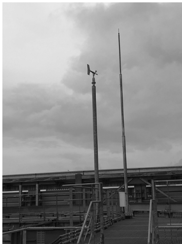
写真6 本館屋上の風向風速計（左側）
