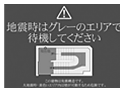
写真12 屋内避難階段 （階段室壁の稼働範囲を色分けして表示） （写真中央のグレーの線は免震水平スリットの位置を示す）
