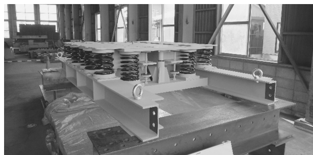
写真3 上下地震用TMD
