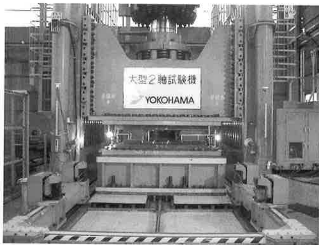
写真-2 大型2軸試験機による積層ゴム性能試験
