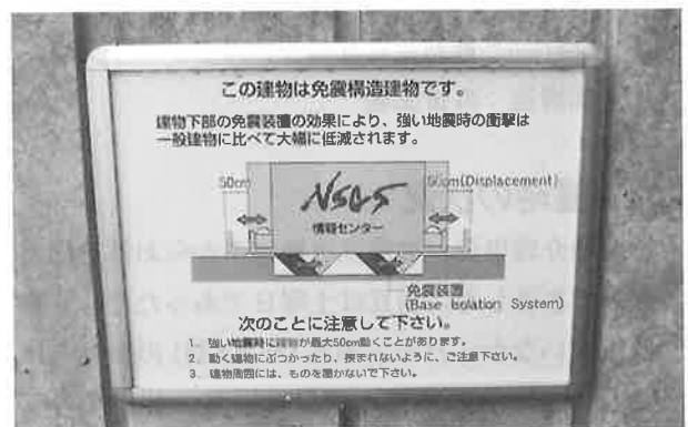
写真3 免震建物の表示
