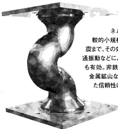
地震のエネルギーをダンパーの塑性変形によって吸収し、熱エネルギーに変換します。比較的小規模な地震から大規模な地震まで、その効果を発揮。また、風や交通振動などによる微小な振動に対しても有効。非鉄金属総合メーカー・住友金属鉱山ならではのノウハウが優れた信頼性に息づきます。
