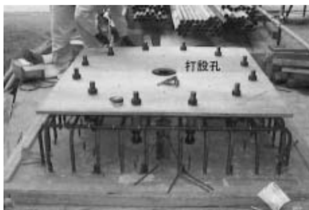
写真6 充填性確認試験・ベースプレートセット状況
