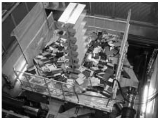
写真2 実験後状況(兵庫県南部地震原波)
