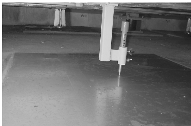
写真4 金属板罫書記録装置の設置状況
