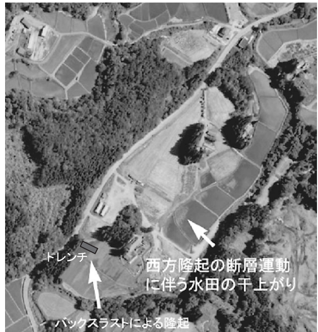
写真8 柵木立地区におけるトレンチ調査位置 (名古屋大学環境学研究科地震火山・防災研究センター ホームページ掲載資料より抜粋)
