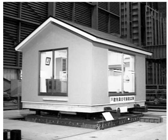
実大免震家屋の振動台実験による検証 (撮影：東急建設)
