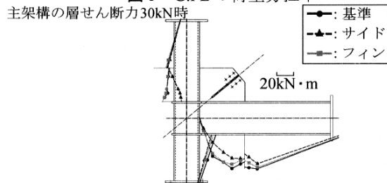
図6 柱梁の負担曲げモーメント分布
