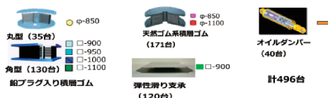
図4 免震装置配置
