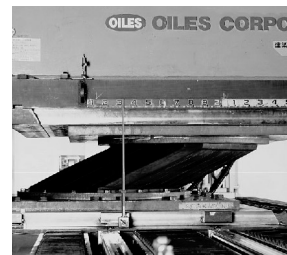
大型試験機によるLRBの大変形性能試験
