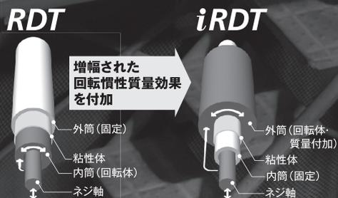
iRDT (慣性こま)は、従来の粘性制震装置RDT (減衰こま)の回転部分を外側に配置して大きな回転慣性質量を付加した装置。
