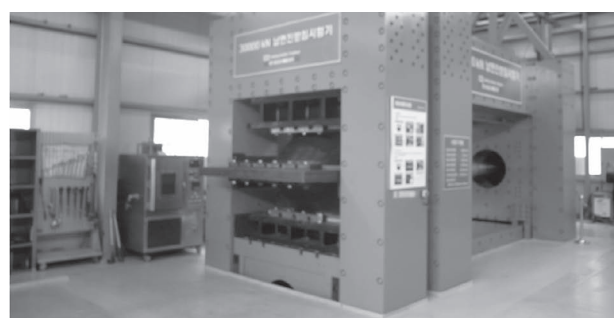
写真3 LRBせん断変形性能試験 (UNISON社)
