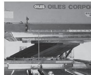
大型試験機によるLRBの大型変形性能試験
