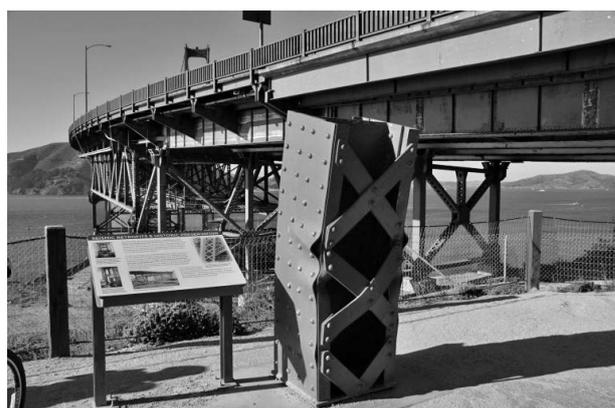
写真4.4 組立トラス試験体の展示
