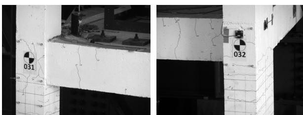
写真8 3次元振動台 公開試験状況
