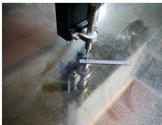
写真 4 郡山市内の研究施設の外観（左）とけがき板の記録（右：東西に 20 mm 程度）
