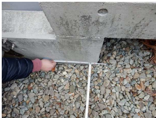
写真 2 福島市内の病院建物の外観（左）と外周部の砂利に残された免震層の移動跡（右：免震建物が周辺の砂利を 4-5 cm 程度押しつけている）
