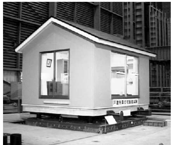
実大免震家屋の振動台実験による検証（撮影：東急建設）
