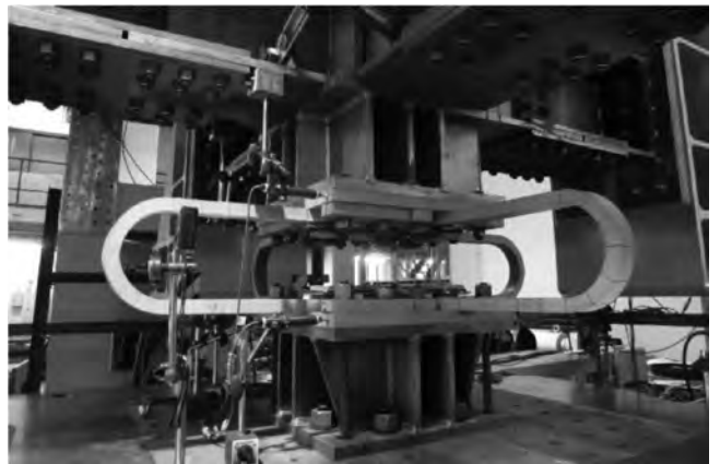
水平 2 方向载荷実験（撮影：山田 哲）
