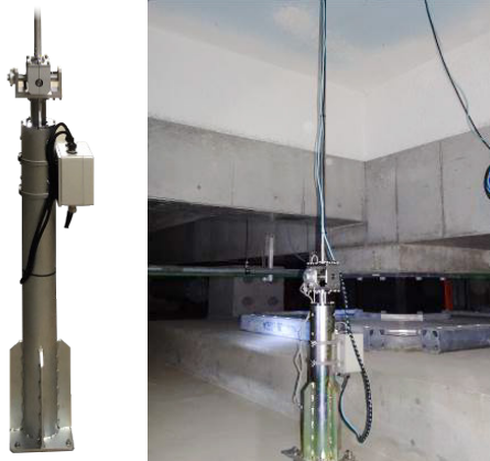
直立型ロングストローク変位計（撮影：株式会社東京測振）
