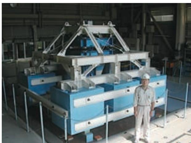
写真3 塔頂免震の振動台実験
