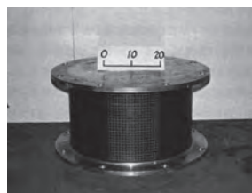
写真4 加硫接着積層ゴムプロトタイプ φ440-5.0×30 ts=3.0mm W=50ton fh=0.5Hz fv=18Hz
