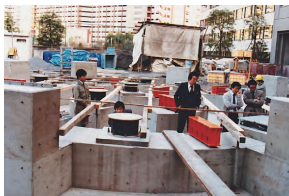
写真6 竹中工務店サイロ免震実験
