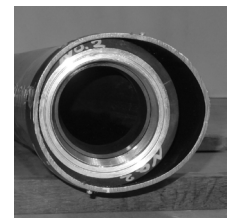
写真2 摺動部の局所変形
