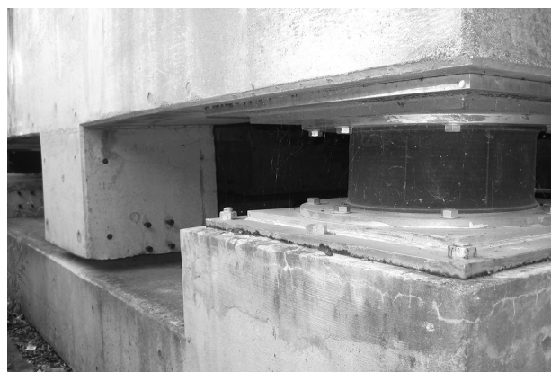
免震構造試験体 免震装置
